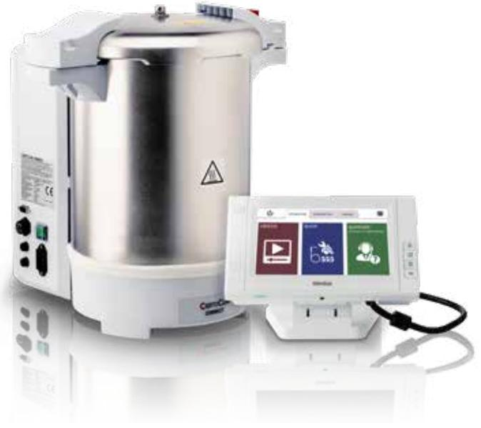
Die Sterilisationskammer besteht aus korrosionsbeständigem, elektropoliertem Edelstahl (316L). Das macht sie extrem robust. Am Boden der Kammer ist eine Heizung angeschraubt, dabei liegen die Heizelemente jedoch nicht direkt im Wasser und können somit nicht verkalken. Dies verlängert die Lebensdauer der Autoklaven.
