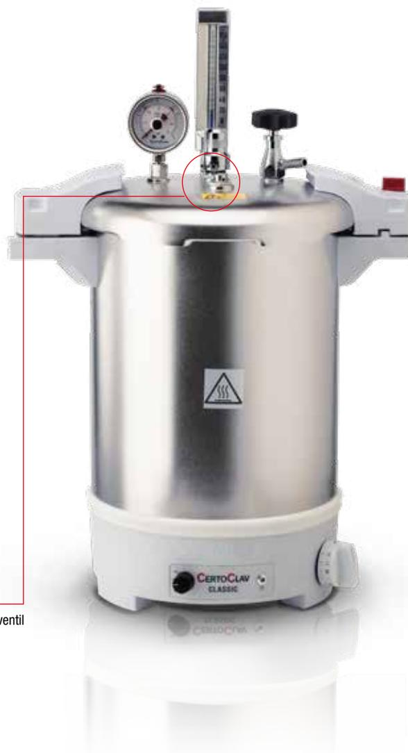
Ideal für die Sterilisation von unverpackten Feststoffen ohne Hohlräume, Flüssigkeiten, Flaschen, Instrumenten und Kunststoffen. Ebenso geeignet für die Nährmedienaufbereitung und Abfallsterilisation.
