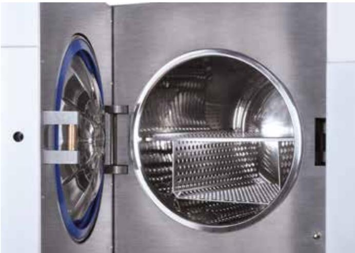
Die Sterilisationskammer besteht aus korrosionsbeständigem, elektropoliertem Edelstahl (304L). Der Dampfgenerator ist in das Gehäuse integriert, von der Sterilisierkammer aber separiert. Das bringt überzeugende Vorteile:
