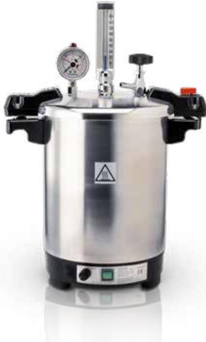
Die Klassiker unter unseren Laborautoklaven sind bereits über 60 Jahre auf dem Markt. Die Dampfsterilisatoren bestehen durch ihre robuste Bauweise, zudem sind sie äußerst wartungsarm. Die Entlüftung erfolgt durch Strömungsverfahren oder fraktioniertes Entlüften.
