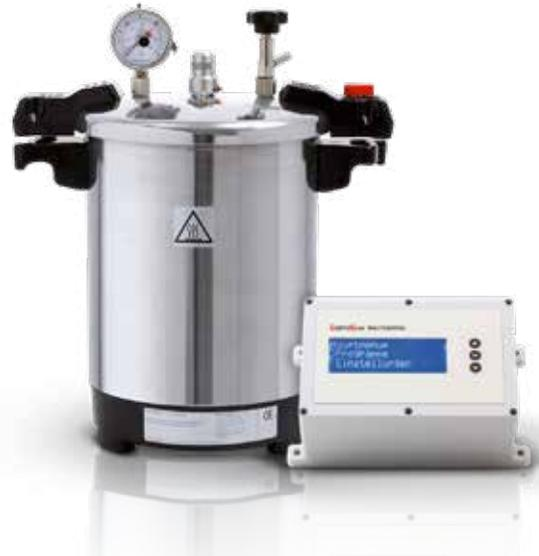
Die Sterilisationskammer besteht aus hochwertigem 3103-Aluminium. In den Boden der Kammer ist eine Heizung eingepresst, dabei liegen die Heizelemente jedoch nicht direkt im Wasser und können somit nicht verkalken. Dies verlängert die Lebensdauer der Autoklaven.
